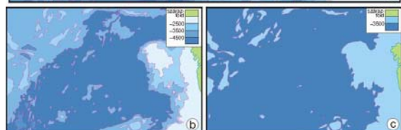
5–5. ábra: Az Ibériai-medence mélységvonalas ábrázolása a) a Kárpát-medencének megfelelő szintközökkel b) 1000 m-es szintközökkel c) 2000 m-es szintközökkel
