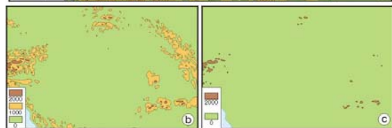
5–4. ábra: A Kárpát-medence szintvonalas ábrázolása a) „szokásos” szintfelületekkel b) 1000 m-es szintközökkel c) 2000 m-es szintközökkel
