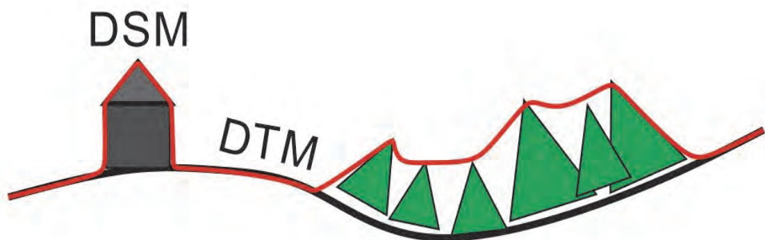
2. ábra: A digitális felszínmodell (DSM, pirossal) és digitális terepmodell (DTM, feketével) különbségének bemutatása.
