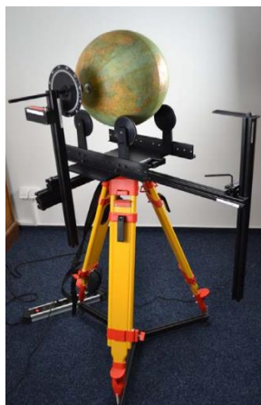
2. ábra A cseh kutatók által kifejlesztett eszköz a glóbuszok digitalizálásához
